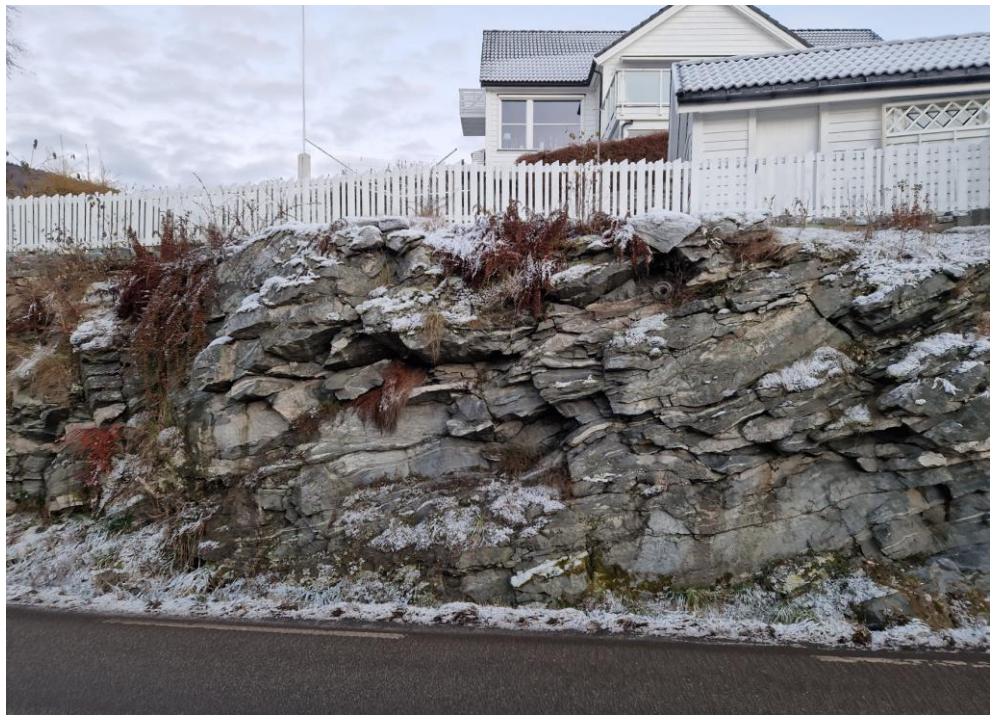
Figur 2: Typisk bergstruktur i prosjektområdet. Gneisfoliasjonen faller nord-nordøst. På mindre skala er foliasjonen foldet. Bilde tatt mot øst ved prøvetakingslokalitet 664 på befaring 17.11.2023.
