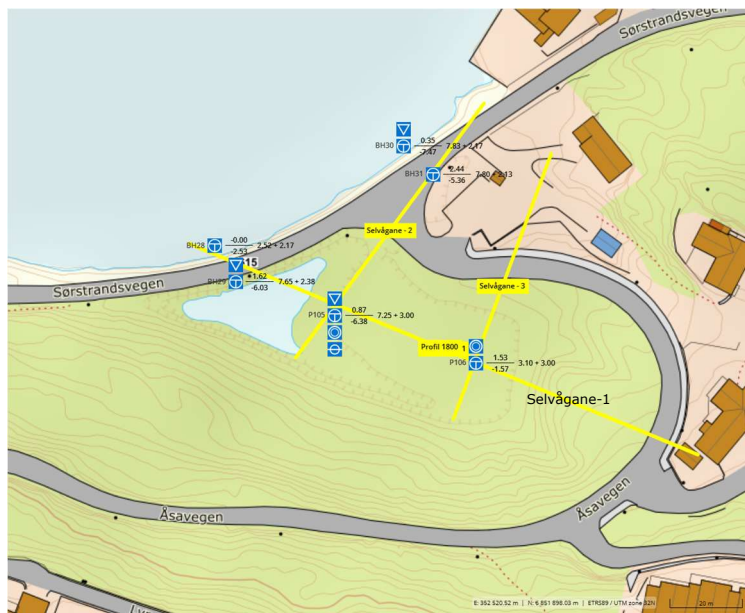
Figur 22: Selvågane. Utførte grunnundersøkelser og snitt som vises i Figur 23, Figur 24 og Figur 25. Det vises også grunnundersøkelser fra 2023 som er relevante for grunnforholdsmodeller og stabilitetsanalyser (BH28-BH31).
