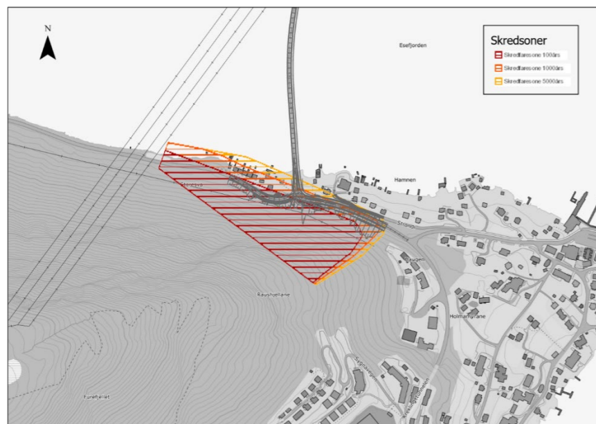
Figur 5.21 Utsnitt fra skredatlas.no. Fareområde for skred sør for Esefjorden. Ny bru er teikna inn.
