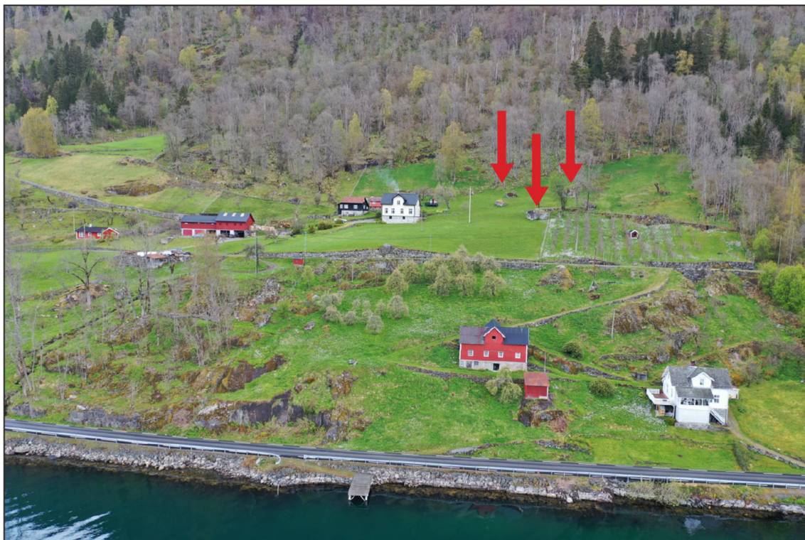
Figur 10: Dronefoto over Grøneng gard på nordsida av Esefjorden, der alternativ 1 er planlagt med landkar/veg i dagen. Enkelte skredblokker er markert i bilde. Ei av blokkene er frå ei skredhending i 1928. Bilde er teke 06.05.2020.
