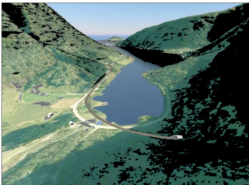
Figur 26: Vegen må heves gjennom Esebotn. Dette vil skape en barriere-effekt mellom fjorden og Esebotn.
