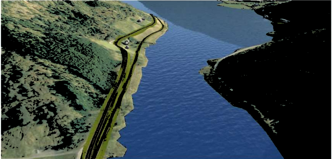
Figur 31: Illustrasjonen viser skissert ny gang- og sykkelveg på nordsida separert frå riksvegen.
