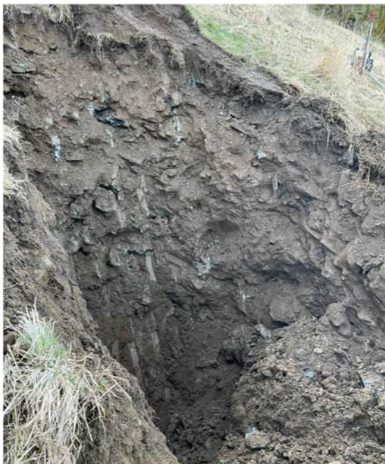
Figur 7 Bilde fra prøvegravning i pkt. E17 (tv) og E47 (th) som viser mer enn 50% innhold av stein og blokk.
