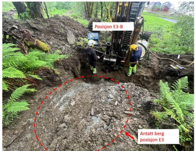
Figur 5 Totalsondering i punkt E3-B med tolkning av antatt dårlig berg og slepper, samt bilde av boring med antatt berg
