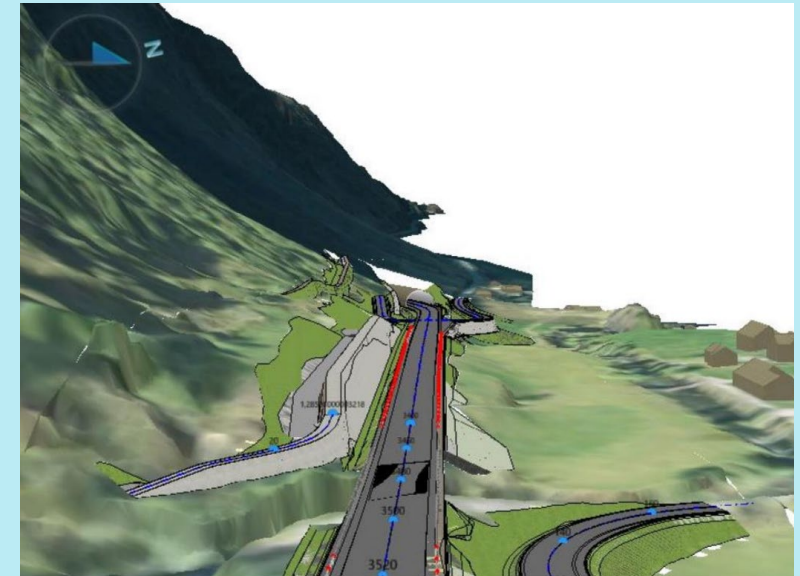
Figur 48 Snip frå prosjertert steinsprangvoll nærast Heilevangbrua og vestover.
