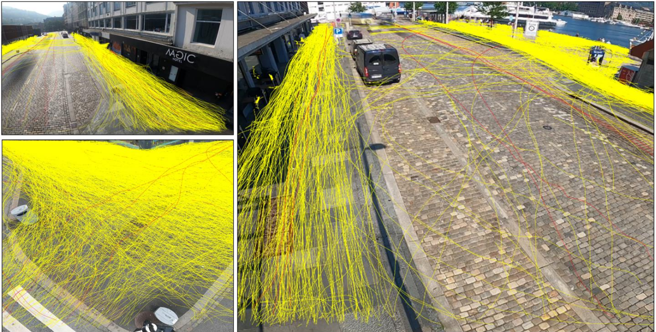
Figur 5-11: Resultatplott fra GoodVision for alle opptakspunkter i delområde 3. Gule linjer er gående, og røde linjer er syklende.
