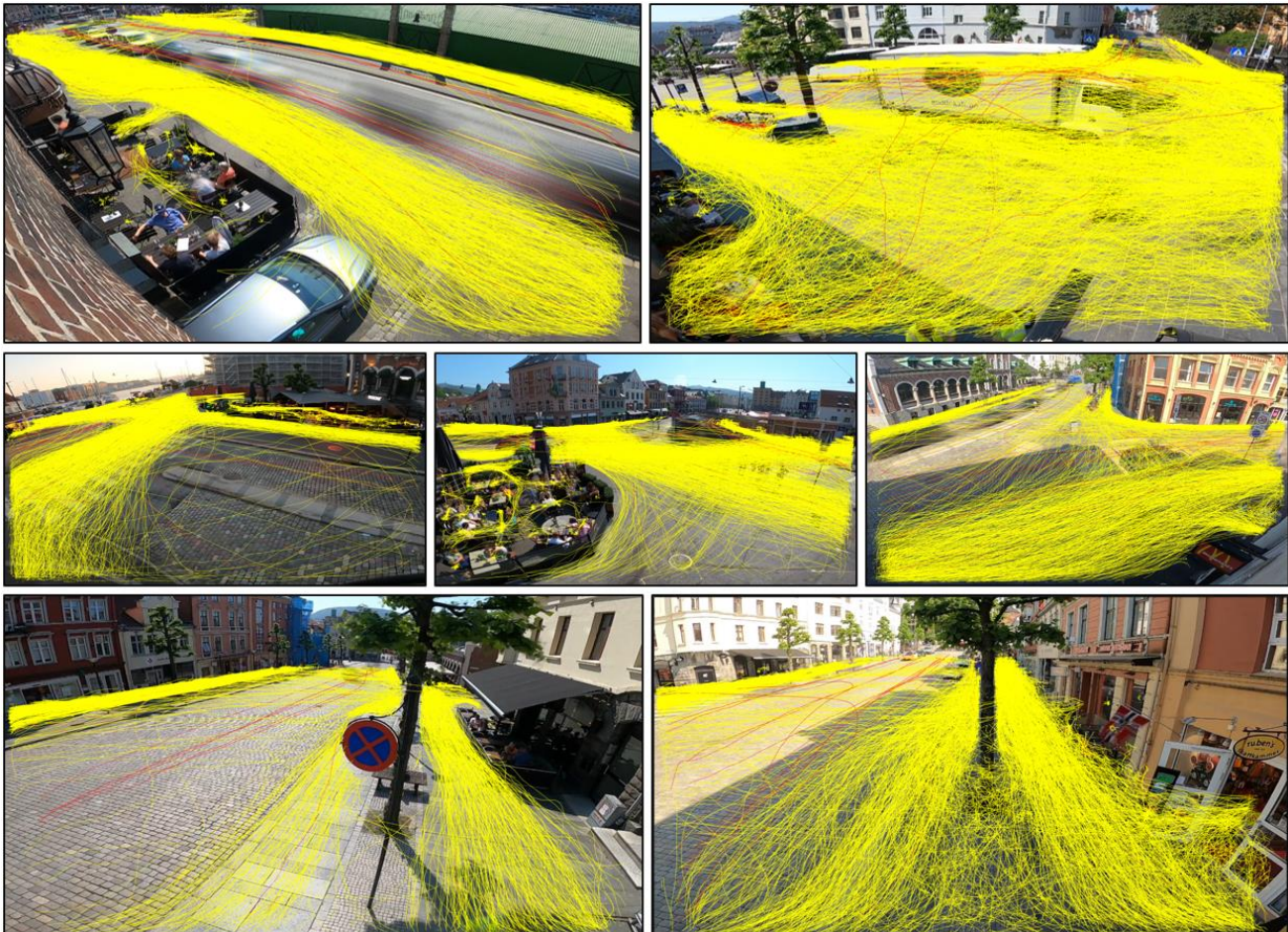
Figur 5-5: Resultatplott fra GoodVision for alle opptakspunkter i delområde 1. Gule linjer er gående, og røde linjer er syklende.
